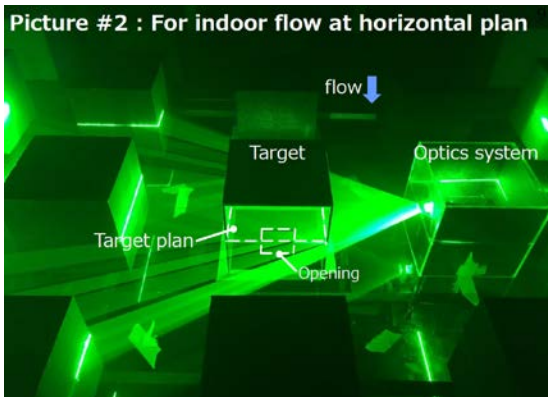
図3 室内気流の水平分布計測のための光学系 (池谷先生の発表資料より引用)
